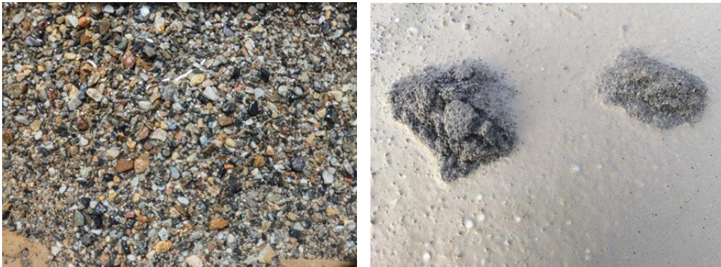
图 2-7 传统地层（左）与岩溶破碎地层（右）出砂粒径对比
